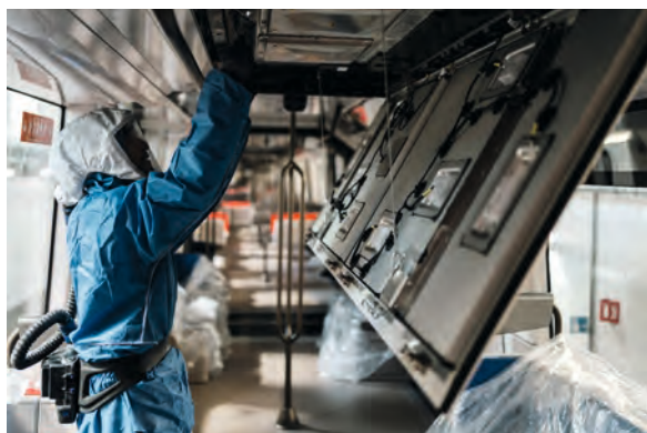
↻ Intervention sur un système de ventilation réfrigéré - Rame de métro ligne 14.
