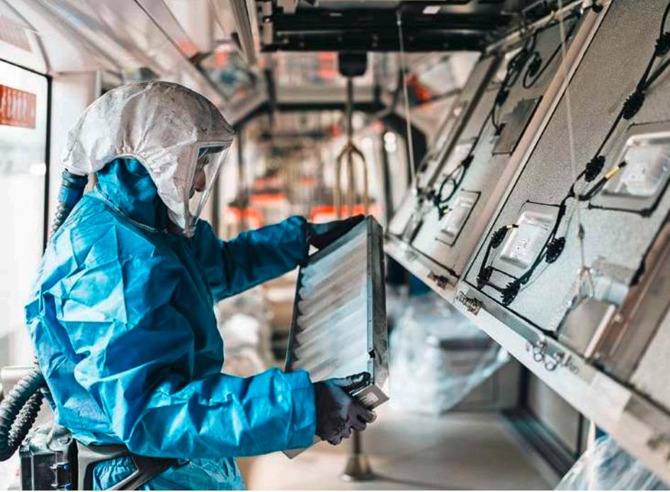
Intervention sur un système de ventilation réfrigérée dans une rame de la ligne 14 du métro parisien. Moins énergivore que la climatisation classique, la ventilation réfrigérée permet de rafraîchir l'air des espaces intérieurs de quelques degrés par rapport à la température de l'air extérieur pour apporter aux voyageurs un confort optimisé.
