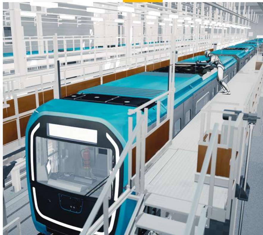
Maquette numérique d'atelier avec simulation d'une opération de maintenance en partie haute du train.
